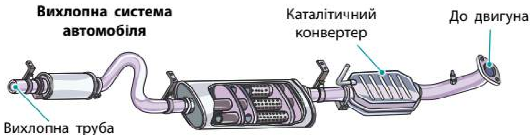
Мал. 20.1. Завдяки каталізаторам у вихлопних газах чадного газу стає набагато менше
