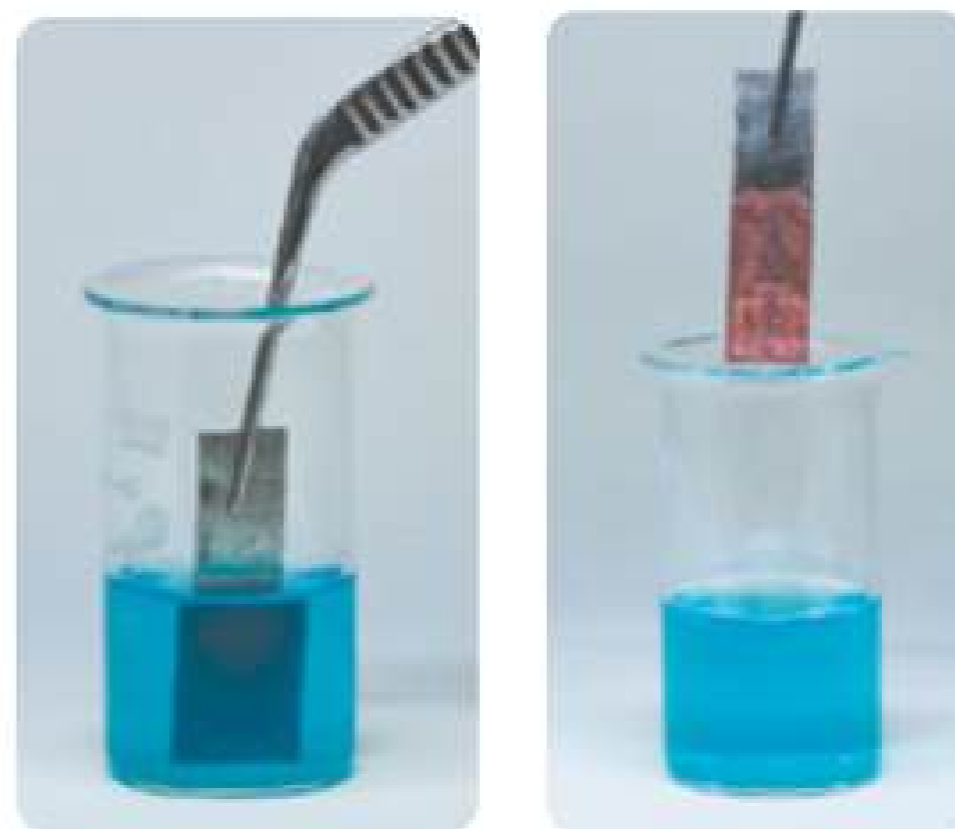
Мал. 18.2. Взаємодія розчину купрум(2+) сульфату із залізною пластинкою
