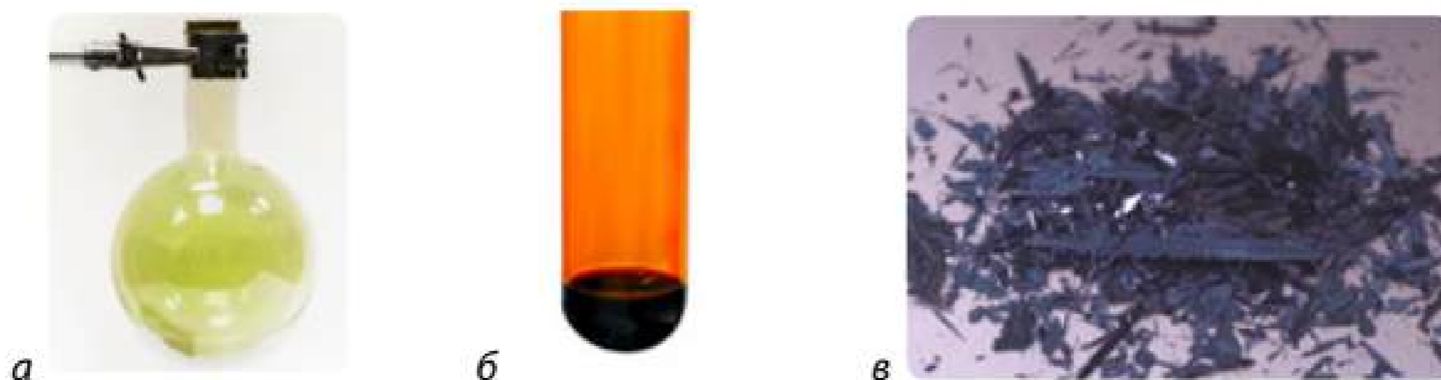
Мал. 26.2. Галогени за звичайних умов перебувають у різних агрегатних станах: хлор — жовто-зелений газ (а); бром — летка рідина червоно-бурого кольору (б); йод — летка кристалічна речовина чорно-фіолетового кольору з металічним блиском (в)
