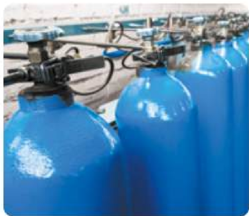
Балони з киснем, пофарбовані в синій колір
